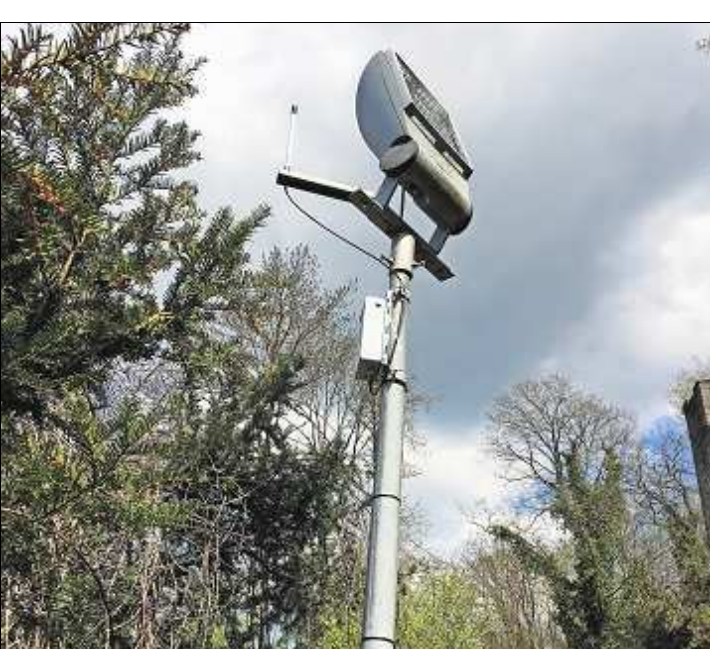
Zwei Basisstationen für das Funknetzwerk „LoRaWAN“ stehen bereits auf dem Schlossberg – zwei weitere sollen noch folgen. Foto: red
